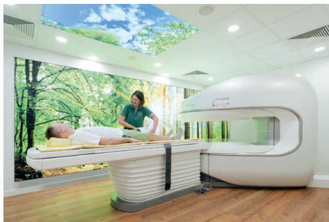
Das offene MRT-System Aperto Lucent (0,4 Tesla) bietet durch sein offenes Ringdesign eine patientenfreundliche Diagnostik – ideal für Menschen mit Platzangst oder für untersuchungsbegleitende Interventionen.
