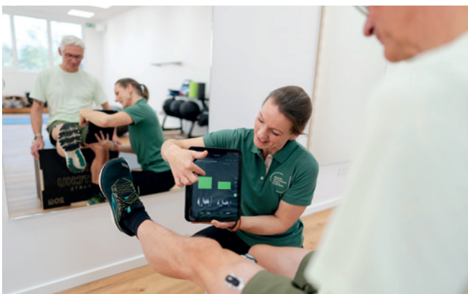
MyoAct ist ein sensorbasiertes EMG-System zur Muskelfunktionsdiagnostik, das die Aktivität und Koordination von Muskeln in Echtzeit sichtbar macht und so eine objektive Grundlage für Therapie, Training und Rehabilitation bietet.
