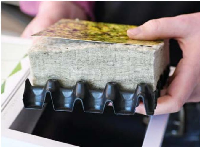
So sieht ein Gründach-System im Muster aus: Wurzelschutzfolie, Drainage-System, Green Roll und Vegetationsmatte.
