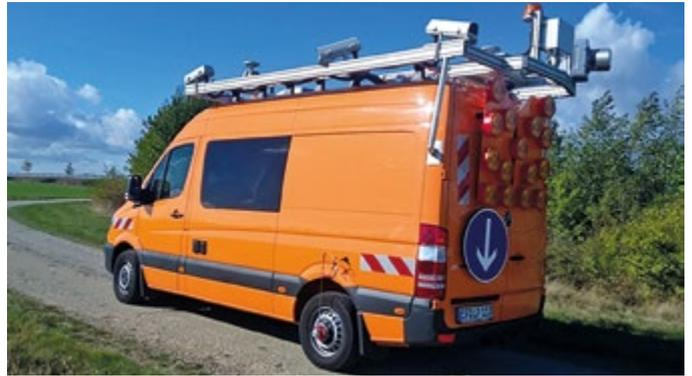
Das Messfahrzeug mit der modernen Kameratechnik auf dem Dach fährt derzeit durch Rietberg. Foto: Ingenieurbüro Lehmann + Partner GmbH
