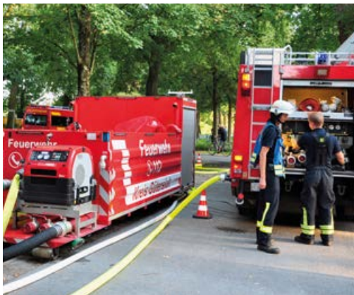
Zentrale Pumpstation verbunden mit 40 cbm Wasserspeicher-Container. Fotos: RSA/Rehling
