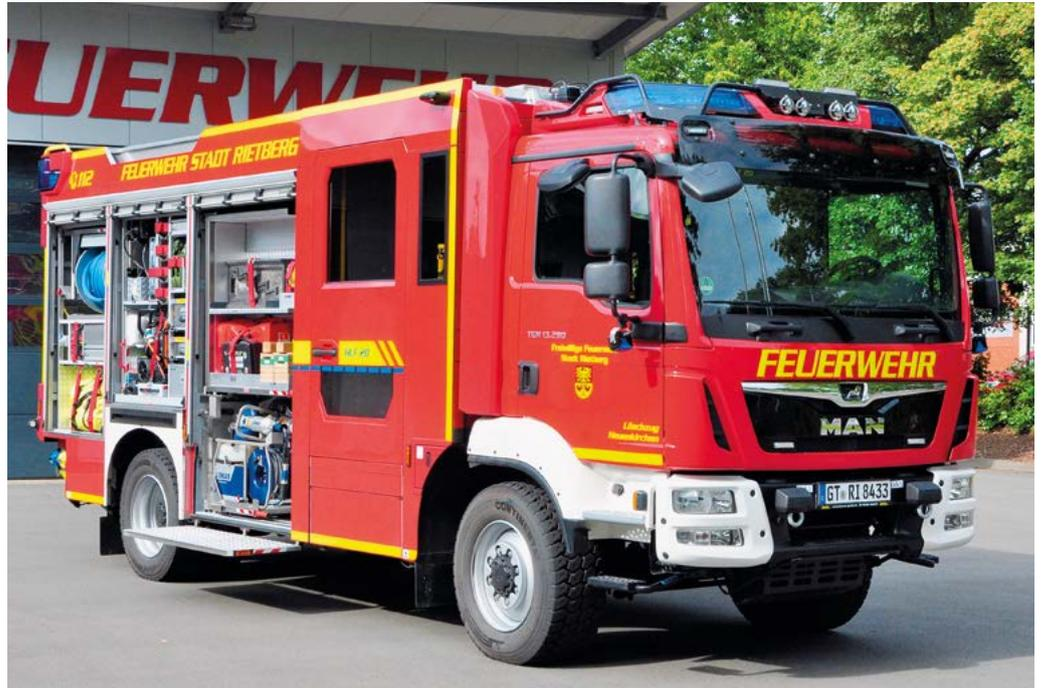
Modernste Lösch- und Rettungstechnik hat das neue Einsatzfahrzeug vom Typ HLF 20 an Bord. Hydraulik-Schere und-Spreizer zur Rettung eingeklemmter Personen. Luftkissen zur Sprungrettung, 2500 Liter Löschwasser, 200 Liter Schaummittel, Lichtmast, große Mannschaftskabine mit Atemschutz-Geräten, digitale Steuerungseinheiten und vieles mehr. So ausgerüstet ist das neue Fahrzeug vor Ort in wenigen Minuten einsatzbereit. Sonntagmittag ist die offizielle Fahrzeugweihe und Übergabe. Foto: RSA/Rehling
