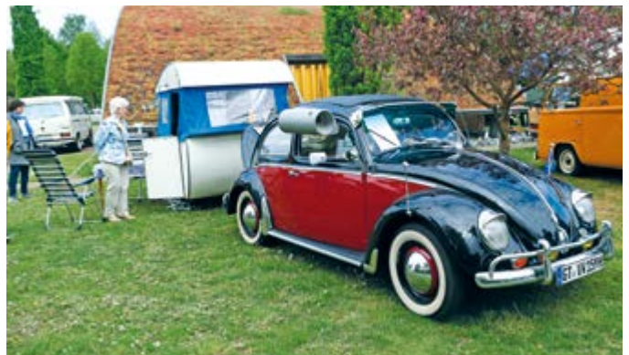
Klimaanlage? Gab es noch nicht. Um Frischluft ins Auto zu leiten, hat man sich früher etwas anderes einfallen lassen, wie diese Röhren am Fenster.
