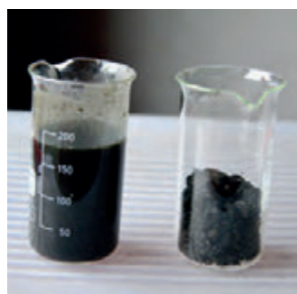
Der vormals flüssige Klärschlamm wird getrocknet.
