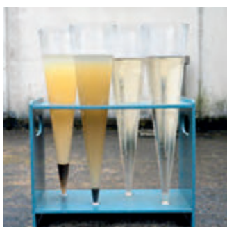
Mittels Aktivkohle werden viele Schwebeteilchen gebunden.
