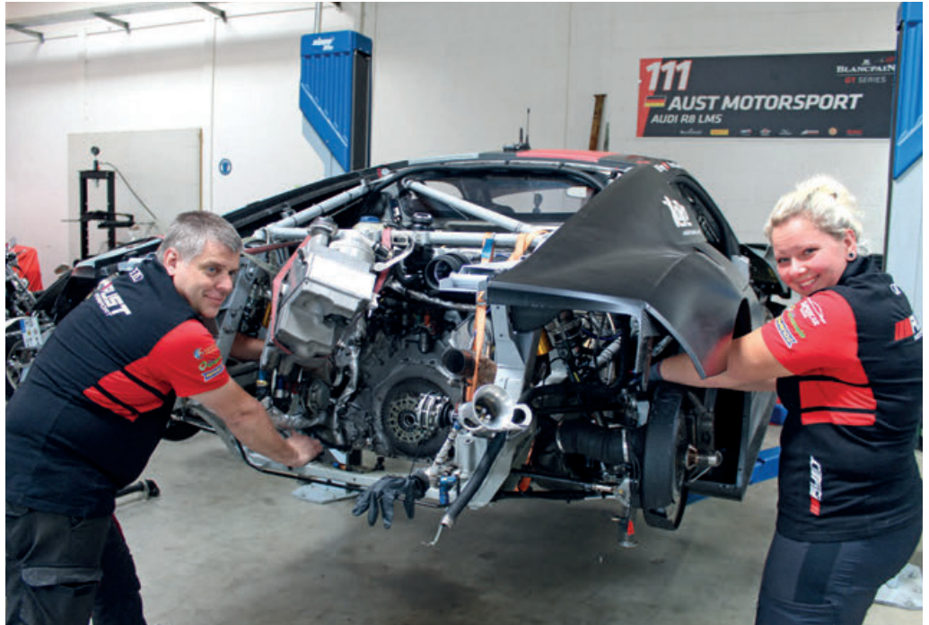
Eingespieltes Mechanikerteam: Sven Harder und Janet Gratzner zerlegen vor jedem Rennen die Autos und säubern und kontrollieren die einzelnen Fahrzeugteile. Foto: RSA/Steinberg
