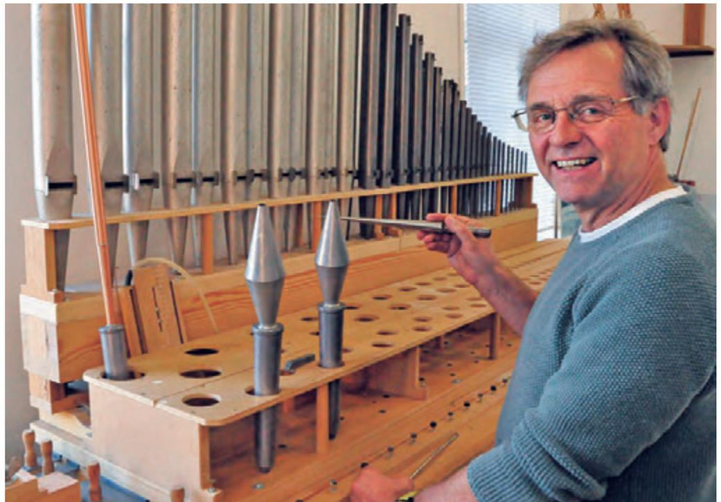
871 Orgelpfeifen werden bei den Renovierungsarbeiten am Hülscheider Instrument vom Orgelbaumeister Ralf Müller an der Intonationslade einzel exakt gestimmt. Fotos: RSA Bell/Rebling
