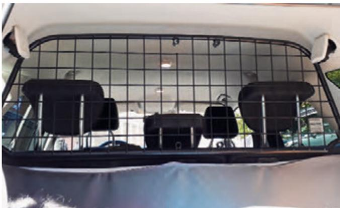
Ein festes Metallgitter zwischen Koffer- und Fahrgastraum stellt sicher, dass ein Tier nicht bei einer scharfen Bremsung zu einem „Wurfgeschoss“ wird
